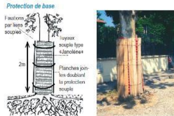
Exemple de dispositif permettant de préserver les troncs des arbres (source : fiche pratique « protection des arbres sur chantier », 2008, Grand Lyon Communauté Urbaine)
