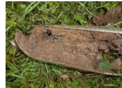
Exemple de sol caractéristique des zones humides et prélèvement réalisé à l'aide d'une tarière (Photos : Naturalia)
